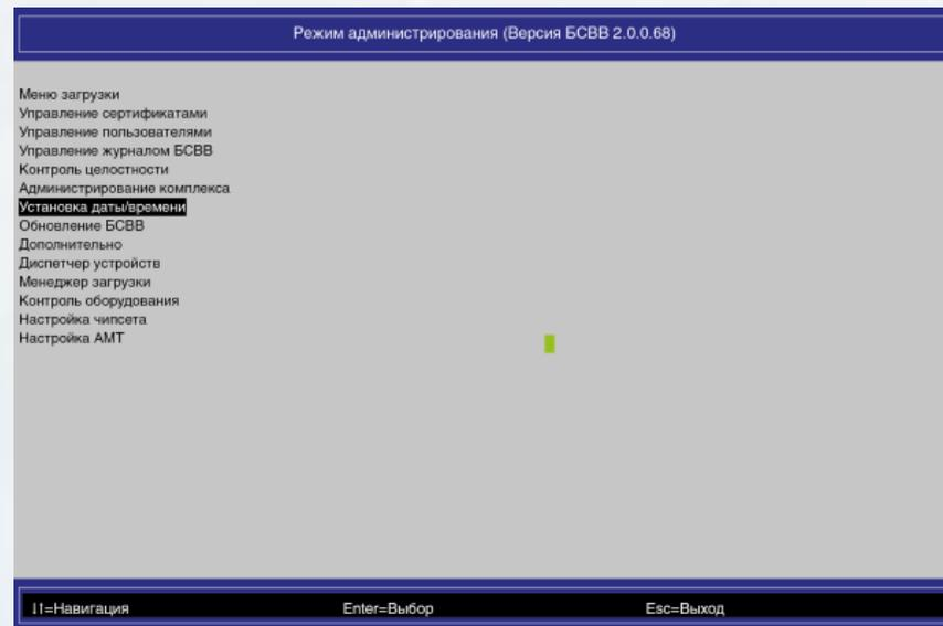
**МДЗ ALTELL TRUST** предназначен для защиты средств вычислительной техники от несанкционированного доступа и обеспечения контроля целостности программной и аппаратной конфигурации СБТ, на которых он смонтирован, до начала загрузки его операционной системы.
