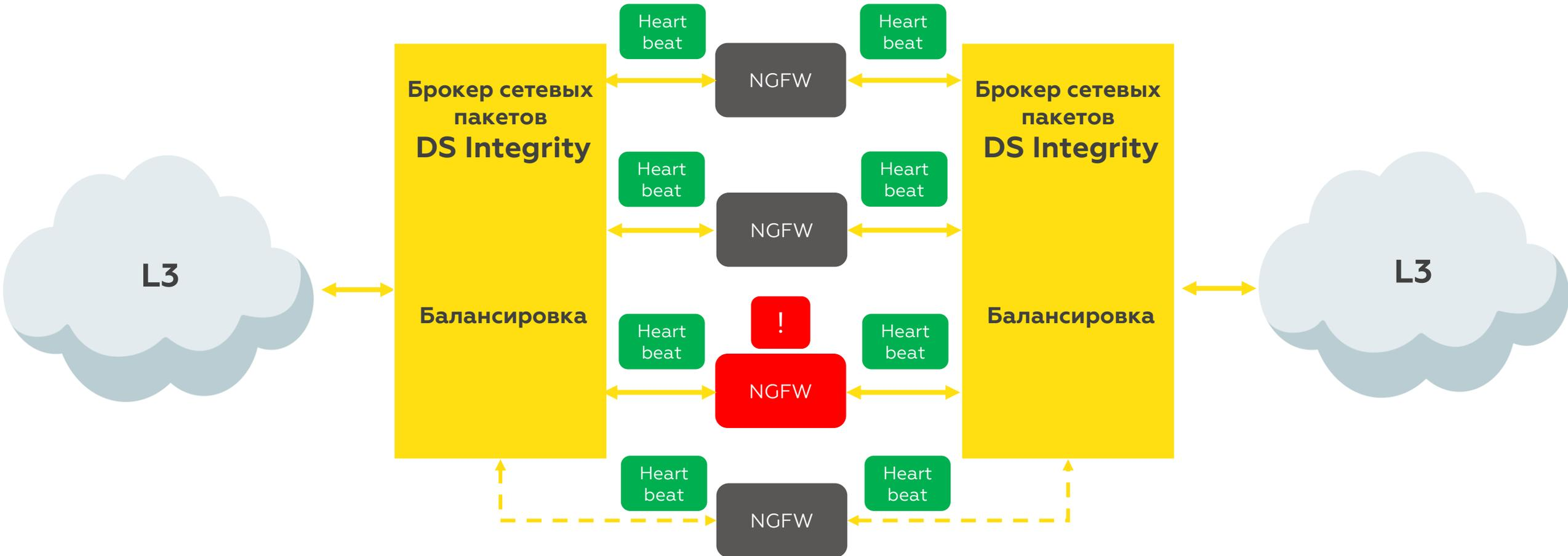
Для контроля работоспособности отдельных устройств, брокер сетевых пакетов DS Integrity NG добавляет в трафик специальные пакеты (технология Heartbeat). Если обнаруживается нерабочее устройство, происходит мгновенная перебалансировка трафика между оставшимися в кластере средствами.
