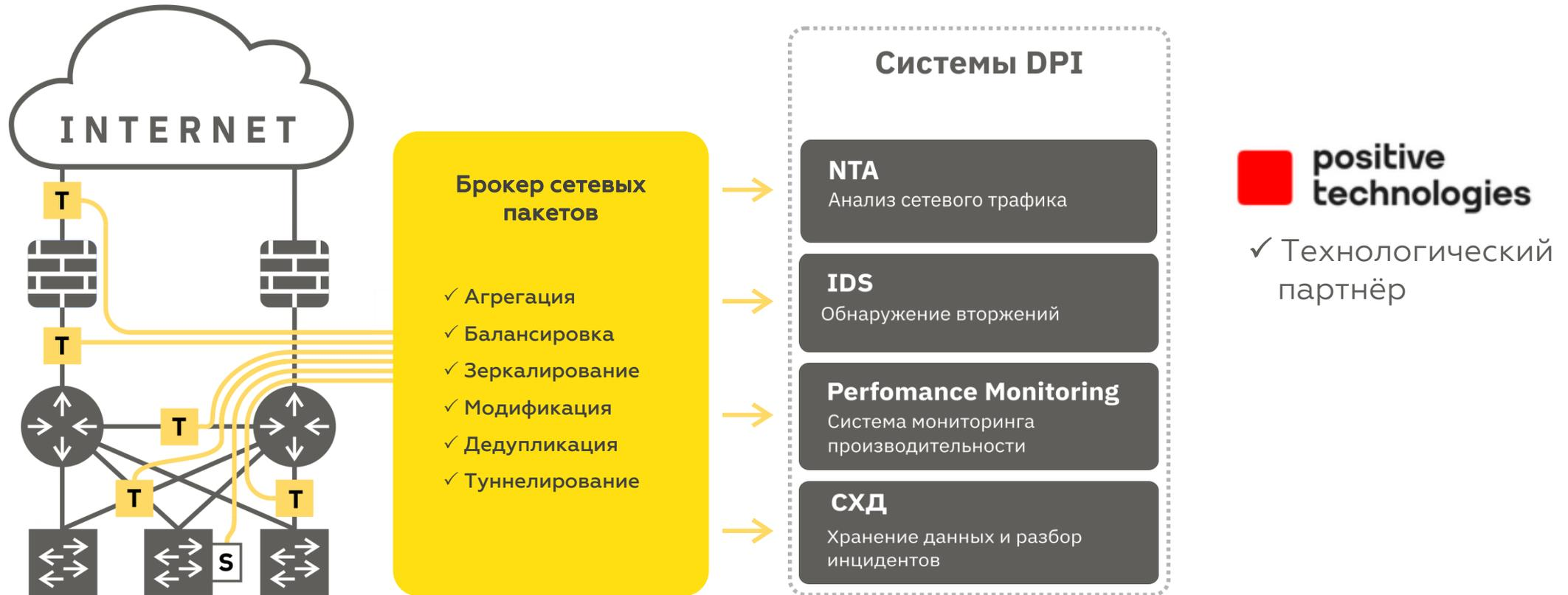
Пассивное подключение брокера сетевых пакетов к ИТ-Инфраструктуре осуществляется через SPAN-порты или ответвители трафика (TAP), например, с помощью ответвителей DS Optic-TAP или DS Copper-TAP
