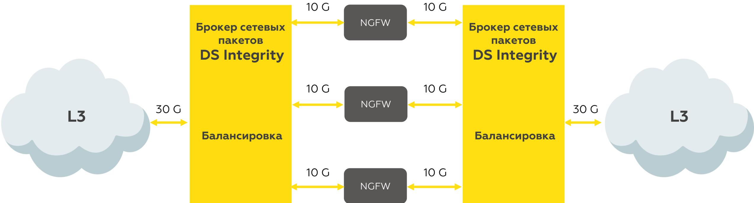
Брокер сетевых пакетов DS Integrity балансирует нагрузку на необходимое количество анализаторов, разделяя потоки трафика с сохранением целостности сессий/потоков
