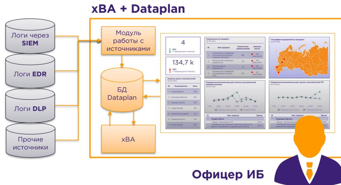
Приложение xBA используется совместно с модулем визуализации данных Datarplan. Решение собирает логи и события из разных бизнес и ИБ-систем, обеспечивая их анализ и визуализацию
